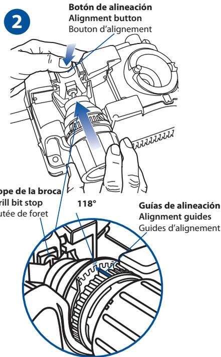
**Insertar el portabrocas en la abertura de alineación, coincidiendo con el ángulo de la broca. Oprimir el botón de alineación, insertar el portabrocas, deslizar la broca hacia delante hasta que toque el tope de la broca y soltar el botón de alineación.**
