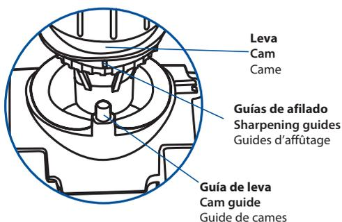
**Alinear las guías de afilado con la guía de leva.**
