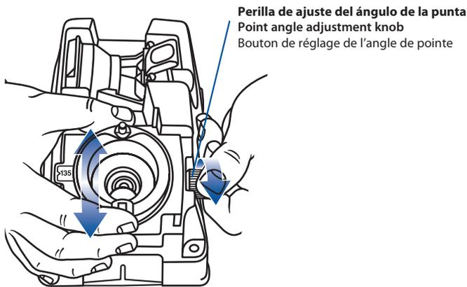
**Aflojar la perilla de ajuste del ángulo de la punta en el lado derecho de la abertura de afilado, deslizar la placa de ajuste de ángulo de la punta al ángulo que se quiera afilar, y volver a apretar la perilla.**
